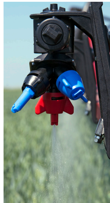
eliminarea colmatării duzelor/ efect de anticoltare
